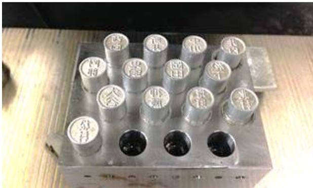
(c) 型彫り放電加工後の印鑑
