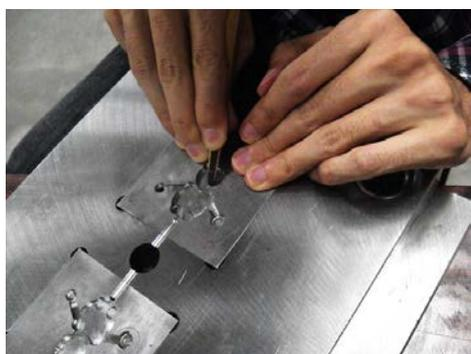
図4 手磨きによる仕上げ加工
