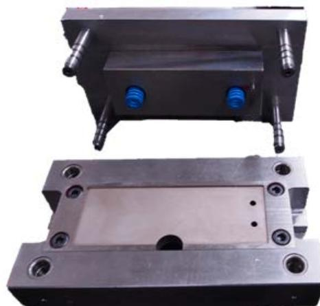
(b) 外形打ち抜き金型
