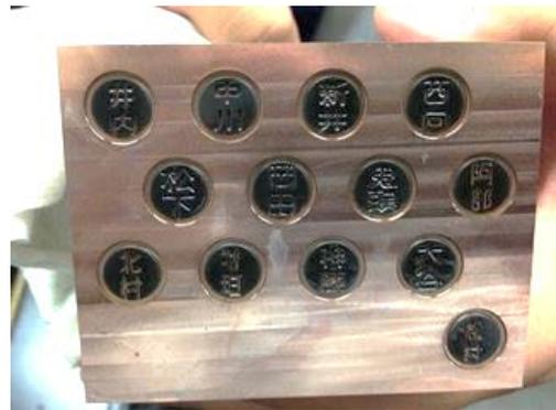
(d) 型彫り放電加工後の電極
