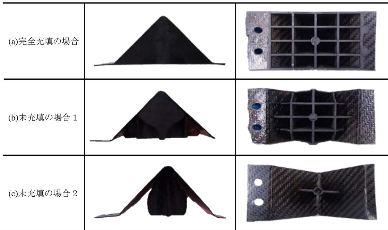
図 10 完全充填およびショートショットした成形品の例
