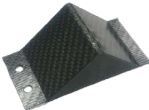
図 9 ハイブリッド成形により得られた衝撃吸収部材の外観
