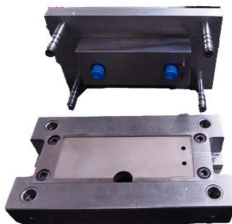
(b) 外形打抜き金型
