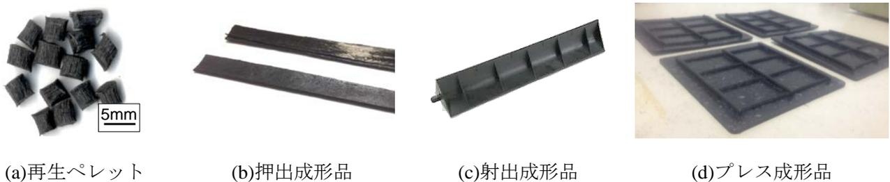
図8 再生ペレットおよび再生成形品の例
