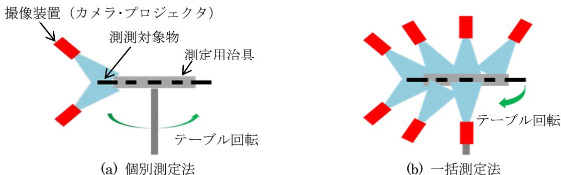
図 10 2 つのデジタル画像計測法
