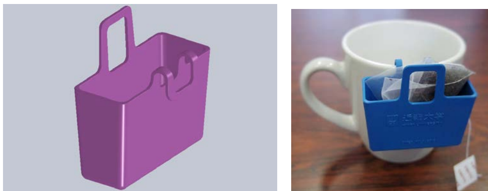
図 30 成形品の 3 次元 CAD モデル，および成形品の利用例（原田孝教授撮影）
