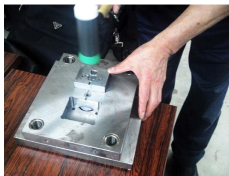
図5 手作業による組立
