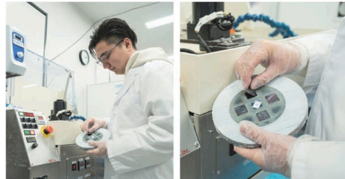
化学機械研研装置でウェーハチップを研磨している様子
