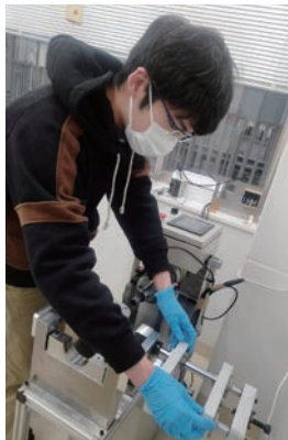
クロスロー軸受の寿命試験準備
