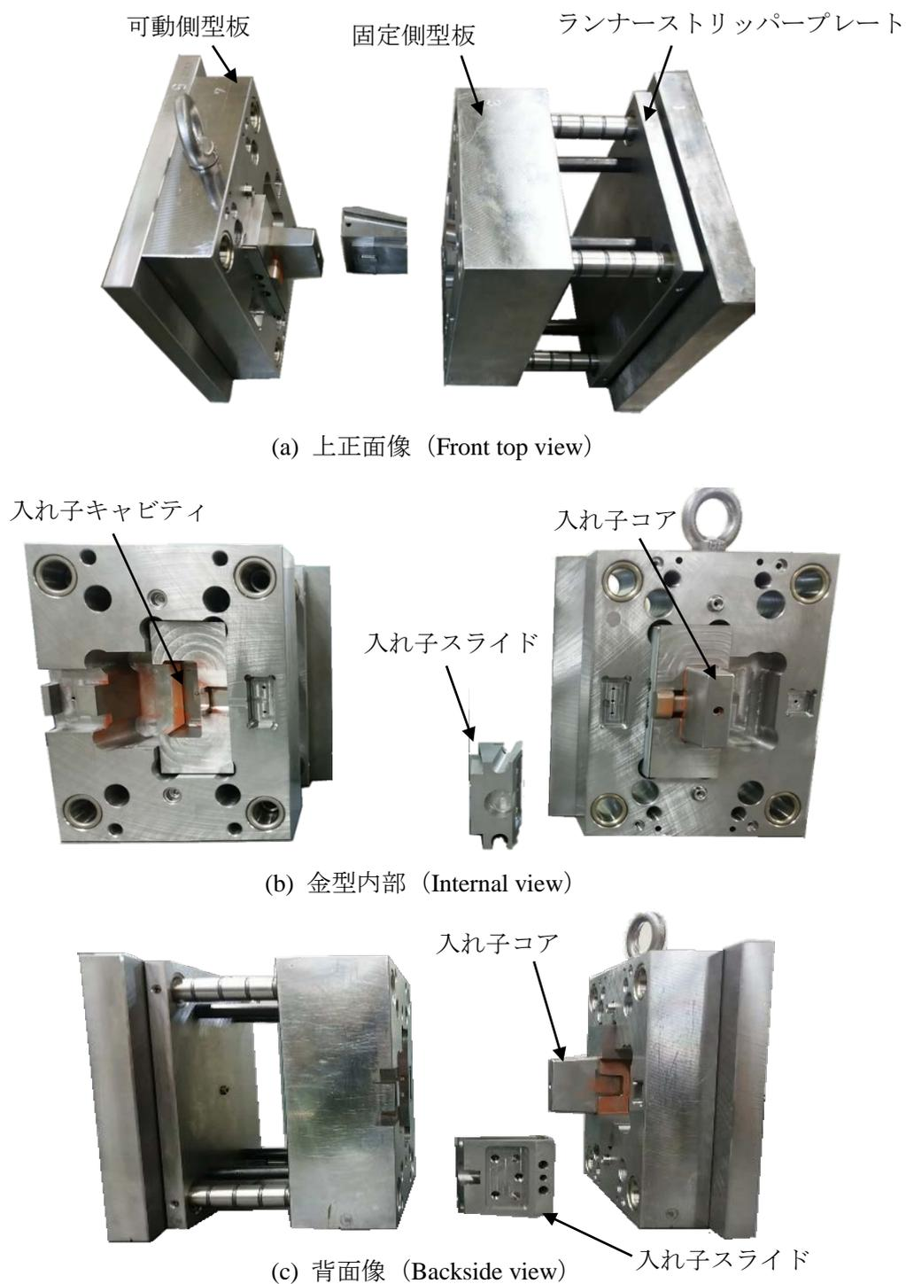
Fig.1 設計・製作した射出成形金型の外観写真 (Photographs of plastic injection mold)
