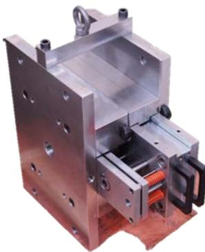
Fig.1 カートリッジ式金型
